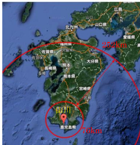
図 27 : イオノゾンデで観測されたスポラディック E のおおよその存在範囲 (赤矢印の範囲)
